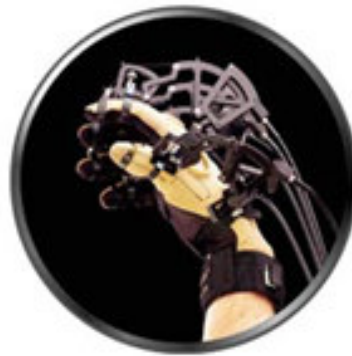
Fig. 16 - CyberGrasp™ Exoskeleton[15] système à retour de force pour les doigts et la main réalisé par Immersion
